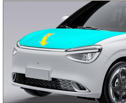
Закрытие крышки отсека силового агрегата
