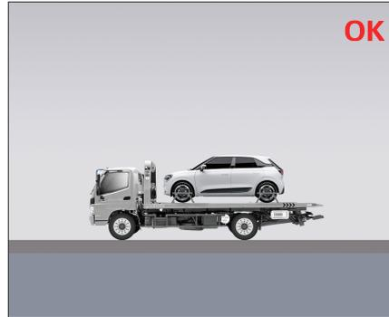
Рекомендуется использовать эвакуатор с бортовой платформой в качестве основного метода, при котором транспортное средство загружается непосредственно в спасательный автомобиль. Это лучший способ транспортировки транспортного средства.
