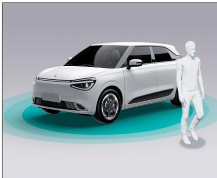
Если включена функция автоматической блокировки замков при выходе из автомобиля, рычаг переключения передач находится в положении P, все двери (включая заднюю) закрыты, ключ находится в руках, и вы отходите от автомобиля (примерно на 3 м перпендикулярно левой дверной ручке или задней двери), двери автоматически заблокируются, скрытые дверные ручки автоматически уберутся\*, а все указатели поворота мигнут один раз.
