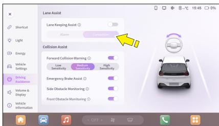
Функцию помощи при удержании полосы движения можно включить/выключить в интерфейсе помощи при вождении MP5 → помощь при удержании полосы движения.
