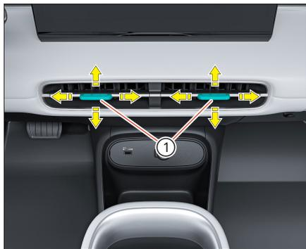
Движущаяся ручка управления **1** регулирует поток воздуха направление (вверх/вниз, влево/вправо) вентиляционного отверстия желаемое положение. Скользящая ручка управления **2** внутрь до упора закрывает вентиляционное отверстие.
