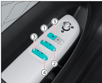
Главный переключатель стеклоподъемников на подлокотнике двери водителя может управлять подъемом и опусканием всех стекол и отключать переключатели управления стеклоподъемниками пассажирских дверей.
