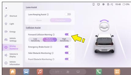
Система предупреждения о лобовом столкновении может быть включена/выключена в системе помощи водителю MP5. → интерфейс помощи при столкновении. Также можно настроить чувствительность предупреждения (низкая, средняя, высокая).
