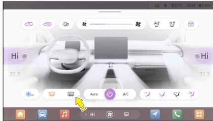
После включения автомобиля нажмите кнопку **ГУФ** оттаивания/размораживания оконных стекол.
