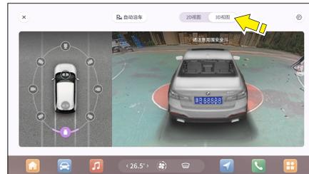
В режиме кругового обзора нажатие значка «2D-просмотр»/«3D-просмотр» позволяет переключаться между режимами панорамного просмотра + 2D-отдельного просмотра и панорамного просмотра + 3D-просмотра.
