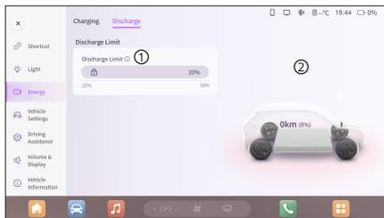
В интерфейсе «Энергия» → «Разрядка» → «Панель параметров предела разрядки» сдвиньте ① влево и вправо, чтобы установить предел разряда, с диапазоном регулировки от 20% до 50%. Когда аккумулятор достигнет предела, всплывающее окно сообщит «Оставшийся аккумулятор достиг предела разряда, прекратите разрядку».
