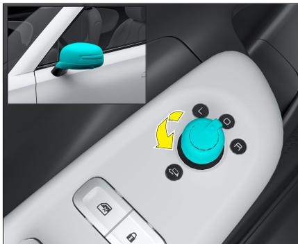
Поверните электрический переключатель складывания зеркала заднего вида, расположенный на подлокотнике двери водителя, чтобы сложить/разложить наружное зеркало заднего вида.
