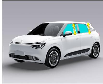
После выключения питания автомобиля нажатие кнопки блокировки/разблокировки на смарт-ключе позволяет управлять автоматическим подъемом/опусканием окон.
