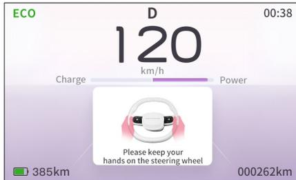
руки на рулевом колесе, сопровождаемые звуковым сигналом. Если водитель продолжает не брать управление на себя, сигнализация будет продолжаться, но функция не будет отключена.
