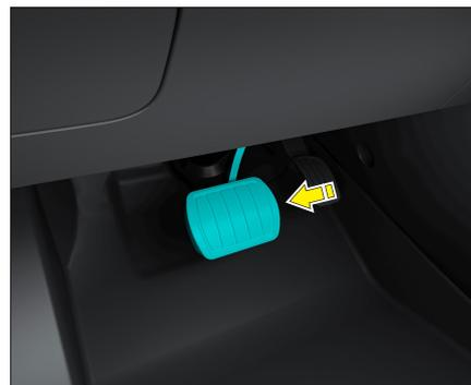
Возьмите с собой смарт-ключ, откройте и сядьте в автомобиль, нажмите на педаль тормоза, автомобиль запустится и перейдет в состояние READY, а на панели приборов загорится индикатор READY.
