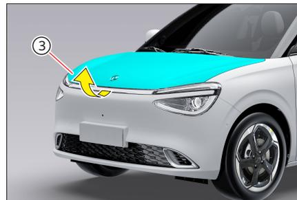
3. Поднимите крышку отсека силового агрегата... вверх.
