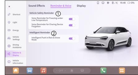
В разделе «Громкость и дисплей» → «Напоминания и голос» → «Панель параметров напоминаний о безопасности транспортного средства»<sup>1</sup>, Вы можете установить следующие звуковые оповещения: звук оповещения о непристегнутом ремне безопасности и звук оповещения о низкой температуре и замерзании.
