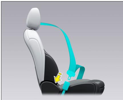
При экстренном торможении или столкновении ремень безопасности удерживает водителя и пассажиров на сиденьях, предотвращая повторные столкновения с другими частями внутри автомобиля, а также обеспечивая оптимальную защиту от срабатывания подушек безопасности.
