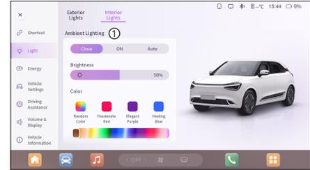
В освещении → Внутренний интерфейс → ОГНИ ①, ты Панель параметров окружающего освещения можно настроить окружающее освещение: Закрыть, Вкл и Авто. Вы также можете настроить яркость окружающего освещения и установить цвет окружающего освещения.
