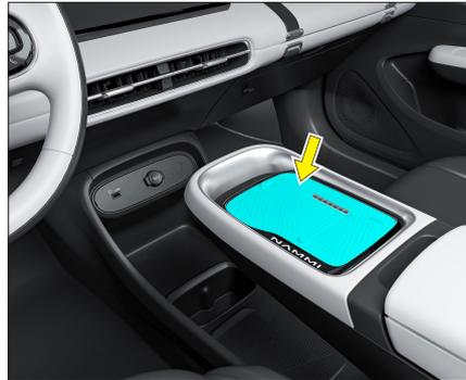
Зона беспроводной зарядки мобильных телефонов расположена в передней части приборной панели.
