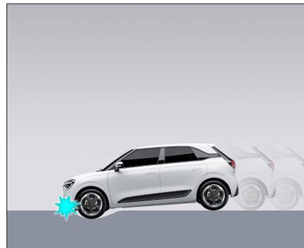
Преодоление глубоких выбоин, приводящее к удару передней части автомобиля о землю, может случайно вызвать срабатывание фронтальных подушек безопасности.
