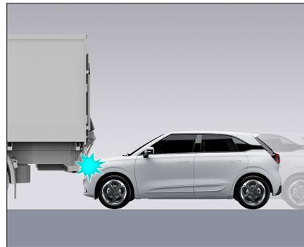
При столкновении сзади с большим грузовиком и попадании под автомобиль фронтальные подушки безопасности могут не сработать.
