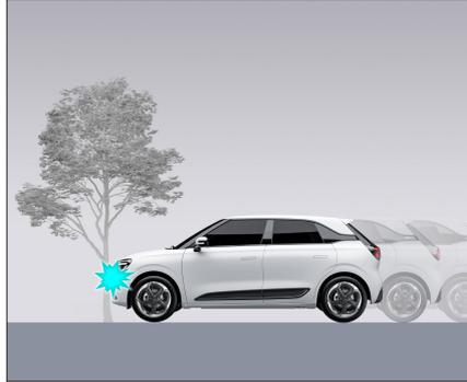
Если автомобиль сталкивается с более тонкими или менее жесткими столбовидными объектами, такими как электрические столбы или деревья, фронтальные подушки безопасности могут не сработать.
