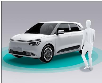
Если включена функция автоматической разблокировки при приближении к автомобилю, возьмите ключ и подойдите к автомобилю (примерно на 1,5 м от ручки левой передней двери или задней двери), двери автоматически разблокируются, скрытые дверные ручки автоматически выдвинутся\*, а все указатели поворота мигнут дважды.
