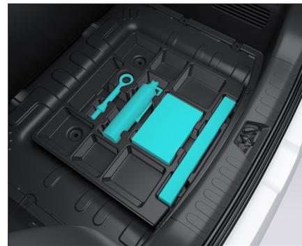
Бортовые инструменты хранятся под пенопластовой прокладкой под полом багажника и закреплены за задней панелью. Доступ к ним можно получить, подняв пол багажника.
