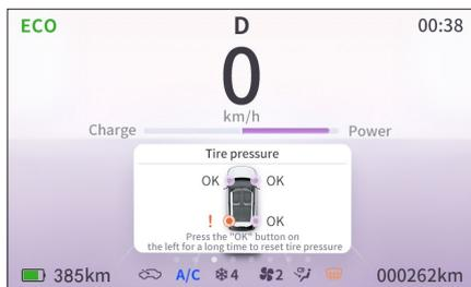
Он также может отображать информацию о контроле давления в шинах.
