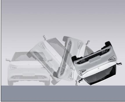
В случае опрокидывания или бокового опрокидывания автомобиля фронтальные подушки безопасности могут не сработать.
