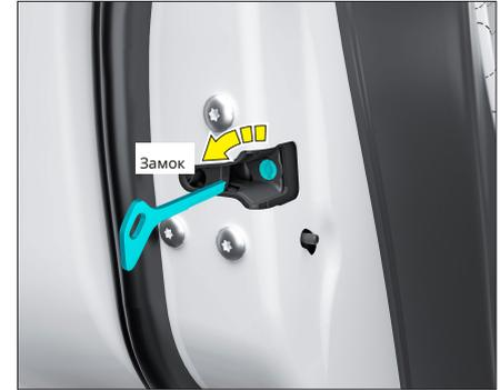
1. Откройте дверь, каждая дверь имеет аварийный выключатель блокировки, вставьте механический ключ в выключатель;
