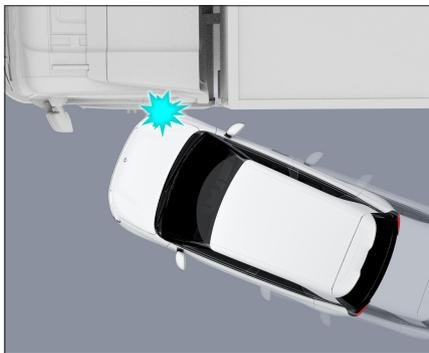
При столкновении автомобиля с дорожным ограждением или другими транспортными средствами спереди сбоку фронтальные подушки безопасности могут не сработать.
