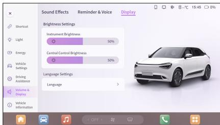
Для моделей с MP5: отрегулируйте яркость панели приборов в меню MP5 Volume & Display. → Интерфейс дисплея.
