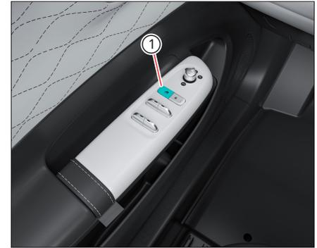
Нажмите на переключатель отключения функции всех органов управления стеклоподъемниками пассажирских дверей; однако переключатель стеклоподъемника со стороны водителя по-прежнему может работать для подъема и опускания стекла.
