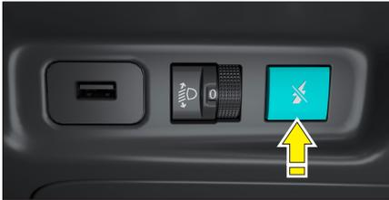
Модели с физическим выключателем питания: Длительно нажмите выключатель питания на левой стороне приборной панели, чтобы выключить питание автомобиля.
