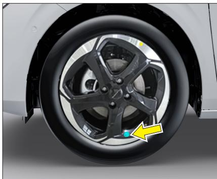
1. Снимите колпачок с вентиля шины и проверьте наличие утечек воздуха, используя метод мыльного раствора.
