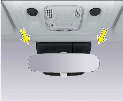
Окно микроволновки расположено вокруг зеркала заднего вида в автомобиле, и в этой области может быть установлено коммуникационное оборудование, такое как ETC, контроль доступа, интеллектуальная парковка и другое оборудование. Солнечная пленка не допускается в этой области для обеспечения эффективного считывания данных.
