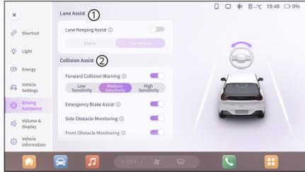
В панели опций «Помощь при вождении» → «Помощь в удержании полосы движения»<sup>1</sup>, вы можете включить/выключить соответствующую функцию помощи в удержании полосы движения и настроить ее с помощью переключателя функций. Выберите «Alert», чтобы включить звуковой сигнал предупреждения при непреднамеренном выезде с полосы движения; выберите «Correction», чтобы помочь в рулевом управлении при непреднамеренном выезде с полосы движения.
