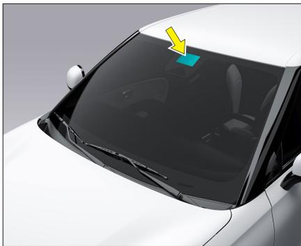
Датчик автоматического освещения расположен в середине верхней части лобового стекла. Не закрывайте эту область и держите ее в чистоте, чтобы не повлиять на функцию автоматического управления освещением.
