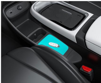
Если батарея смарт-ключа разряжена, поместите смарт-ключ в зону аварийного запуска (как показано на рисунке), закройте все двери и нажмите педаль тормоза, чтобы запустить двигатель автомобиля в экстренной ситуации.
