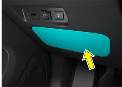
Доступ к блоку предохранителей в салоне можно получить, сняв защитную панель, расположенную в нижней левой части приборной панели.
