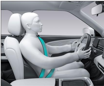
Правильное положение водителя на сиденье может снизить утомляемость за рулем и обеспечить безопасность транспортного средства.
