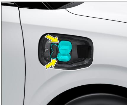
Снимите пылезащитную крышку, чтобы открыть порты зарядки.
