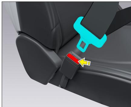
Нажмите красную кнопку на пряжке, чтобы разблокировать замок ремня безопасности. После разблокировки слегка нажмите на ремень безопасности по направлению к верхней точке крепления, и он автоматически втянется в натяжитель.
