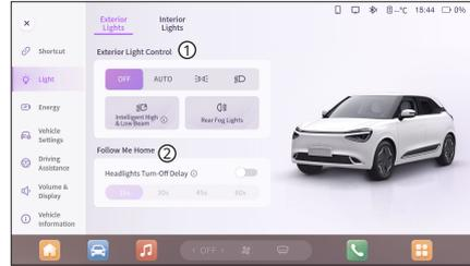
В интерфейсе Освещение → Внешнее освещение → Панель параметров управления внешним освещением ①, вы можете настроить внешние фары: Выкл., АВТО, Габаритный свет, Ближний свет и Задний противотуманный свет. Некоторые модели также могут устанавливать интеллектуальный дальний свет\*.
