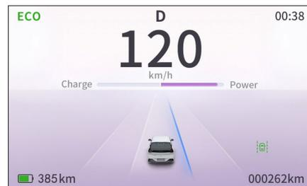
при риске отклонения от полосы движения и без использования сигнала поворота соответствующая линия боковой полосы вмешательства становится синей.
